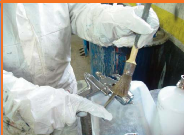
Gants en laminé multicouches (Pour améliorer la dextérité, superposition possible de gants jetables, à jeter en cas de contact)
