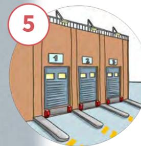
Les quais devront être conçus conformément à l'ED 6059. Un éclairage suffisant des zones de circulation intérieures et extérieures devra être mis en place.
