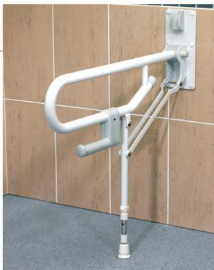
**K** **Barre d'appui relevable :** existe en différentes longueurs. Préconisée lorsque l'approche du WC se fait en fauteuil roulant en permettant ainsi une liberté de passage. Possibilité d'y adjoindre une console de fixation au sol et une béquille relevable pour renforcer sa résistance lors de l'utilisation par une personne de forte corpulence.
